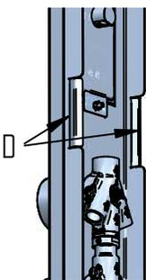
Spingere delicatamente la parte estetica della colonna doccia verso la parte incasso fino al suo totale inserimento. Al centro della parte estetica che stiamo posizionando troviamo due alette (D), regolabili tramite una pinza, che, nel caso la parete non sia completamente diritta, aiuteranno a trattenere la parte stessa alla parete: **adeguare le alette con piccoli spostamenti onde evitare il blocco della parte estetica alla parte incasso.**
